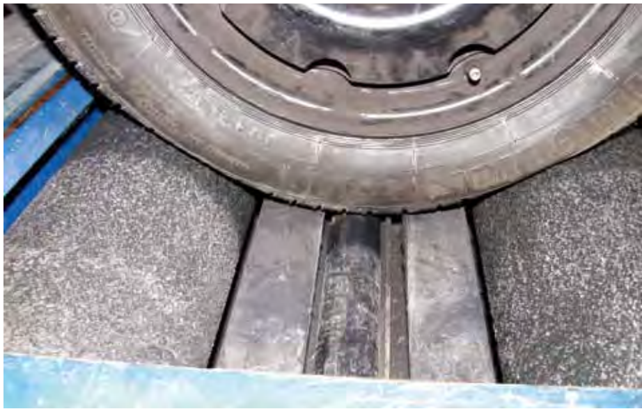
Fig. 1: Prueba 1 medición en banco de rodillos de ITV.
