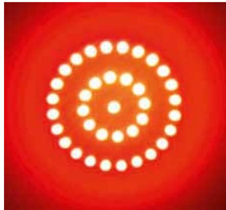
Figura 5. Óptica de ledes con la máscara "Circular 2".
