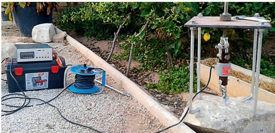
Figura 10. Mecanismo para la medición de la resistencia a tracción de la roca.
