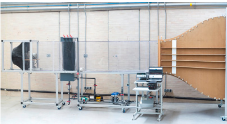
Ilustración 2: Túnel de viento empleado para los ensayos
