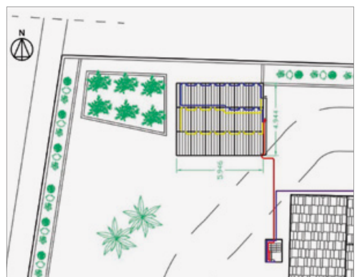
Ilustración 8: Plano Detalle del conexionado de los módulos entre sí y del conexionado de las baterías e inversor
